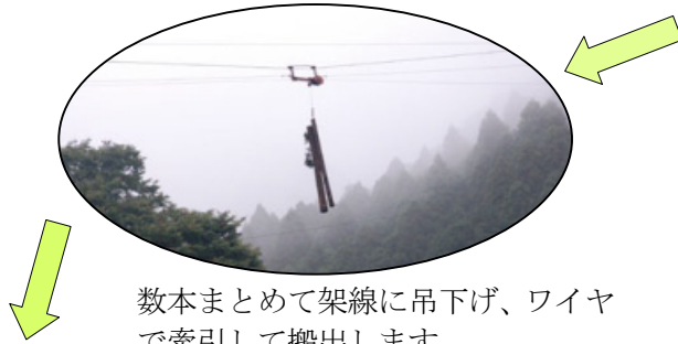
伐採地では自走式のラジコンで木材を搬出場所に集めます。(ラジコンでコンを操作)
