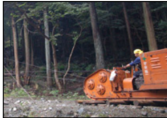
集材機（伐採地と連絡を取りながら、ワイヤの牽引操作を行います。）
