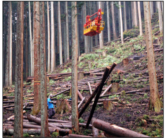
伐採地では自走式のラジコンで木材を搬出場所に集めます。(ラジコンでコンを操作)
